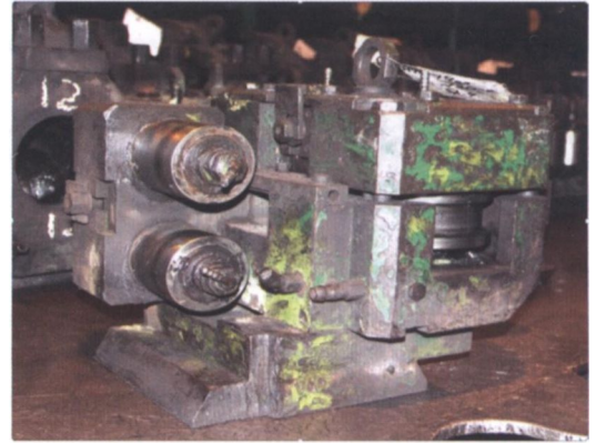
Рис. 4. Внешний вид неприводной универсальной клетки (НУК), применяемой в условиях стана 320 БМЗ
